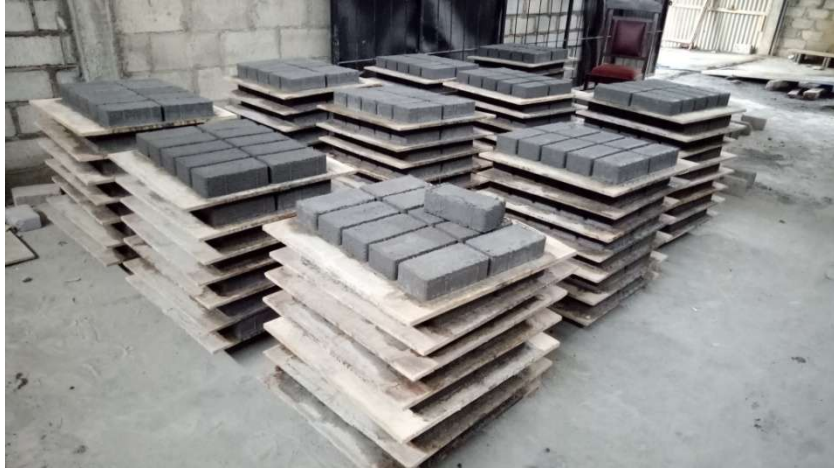
Gambar 8.14 Hasil Paving diletakkan di palet multipleks
